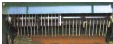
フリーのフレールブレードが52枚付いています
